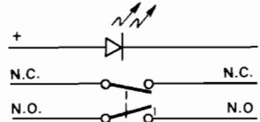
**DOUBLE-POLE SINGLE-THROW (DPST) SWITCH WITH INTERNAL LED**
